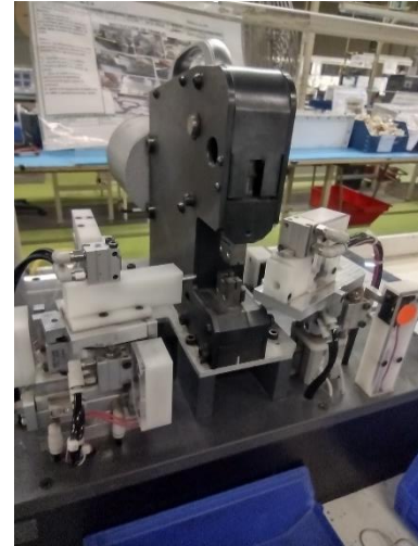
Crimpadora semiautomática con poka yoke
