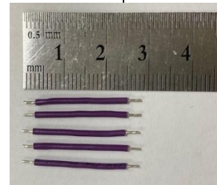
Soldadura de ambos lados
